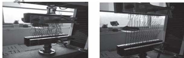
(a) 纵向拉伸破坏; (b) 横向拉伸破坏 a—纵向拉伸破坏; b—横向拉伸破坏
