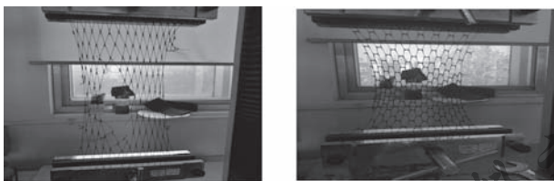
(a) 纵向拉伸破坏; (b) 横向拉伸破坏 图7 单层网拉伸破坏照片
