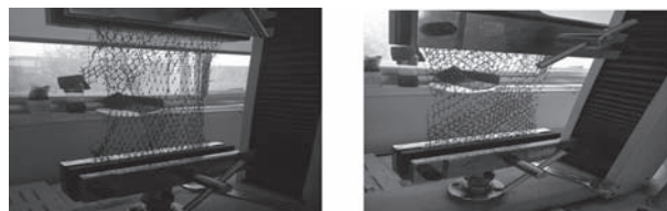
(a) 纵向拉伸破坏; (b) 横向拉伸破坏 图4 三维网垫拉伸破坏照片
